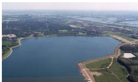
Oeverinfiltratie met een bekken, een voormalige grind-groeve in de buurt van de Maas (WML 2004)
