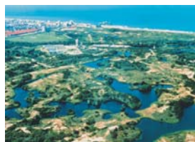
Infiltratievijvers in de duinen langs de Noordzeekust bij Den Haag
